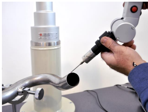
Pomiar rur za pomocą sondy dotykowej
