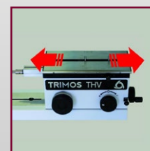
Stolik pływający zwiększający dokładność pomiaru otworów
