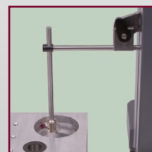
Pomiar rowków wewnętrznych
