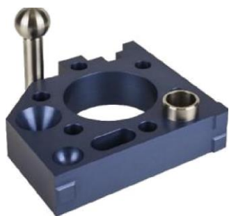
Próbka do badań z kulą kalibracyjną
